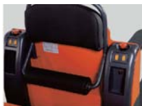
操作舒适方便 后部握持的手柄符合人体工程学,使操作简单安全。后部座位可通过安装孔移位轻松调节。
